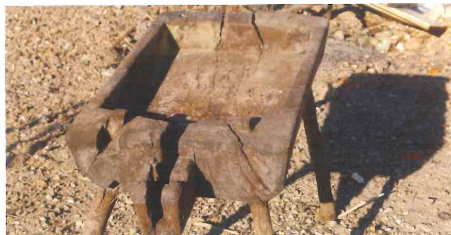
"Lagariça" ou "burra", equipamento para extração manual de azeite Propriedade do sr. Manuel Rosa © Município de Tavira, 2012
