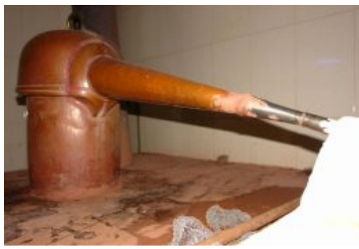
Da esquerda para a direita: 1) Destilaria com dois alambiques. 2) "Cabeça" do alambique vedada com barro. 3) Serpentina do alambique mergulhada em cuba com água.
